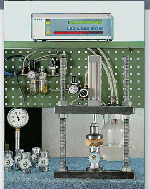
ТЕСТ НА ОТСУТСТВИЕ ПРОТЕЧЕК
